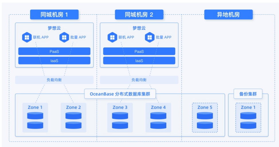
图表 38 云南红塔银行分布式数据库部署架构图
