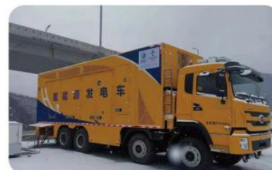
北京冬奥会氢燃料UPS应急电源车 电力保障项目
