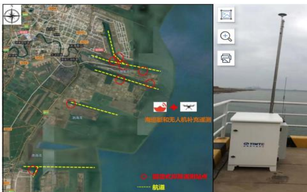
图 2-51-2 天津海域船舶尾气排放遥测站点建设情况
