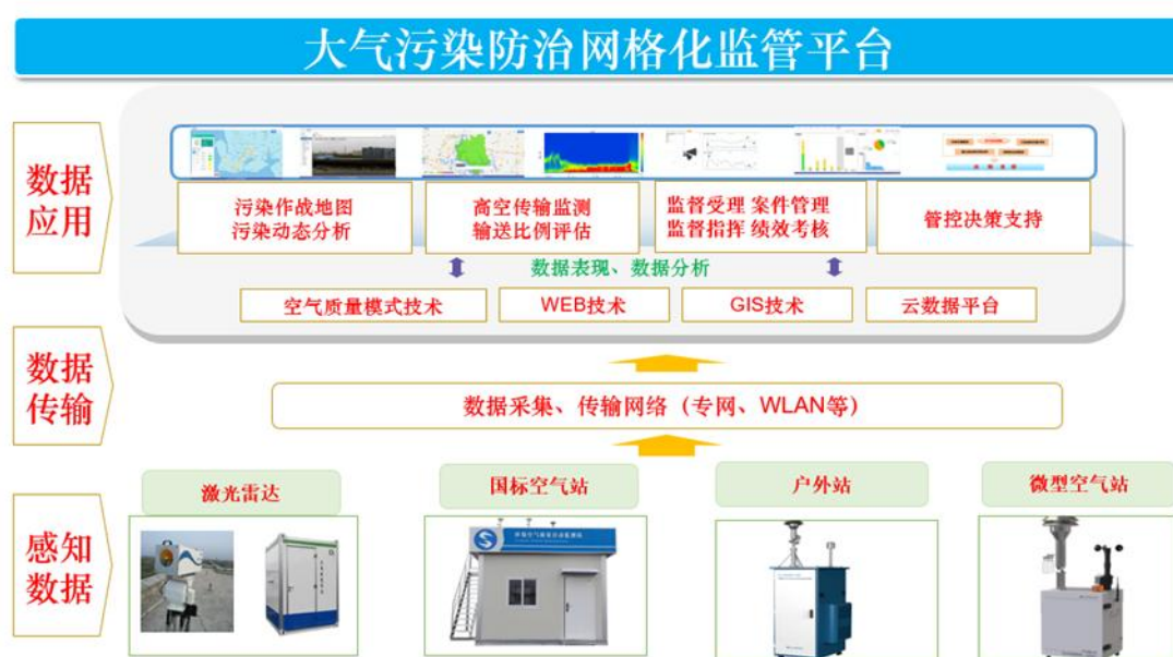
图 2-50-1 大气污染防治网格化监管平台
