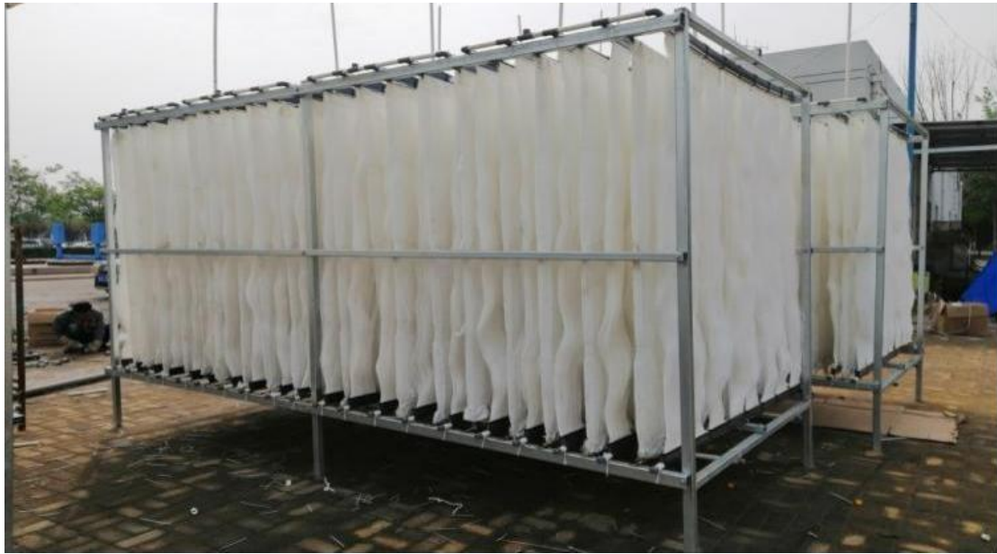
图 2-28-1 MABR 膜块安装示意图
