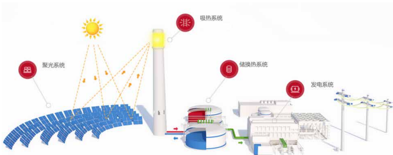
图：熔盐塔式太阳能热发电系统示意图（图片来源：可胜技术）
