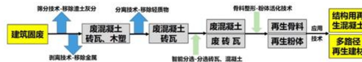
图 46：建筑固废资源化处置工艺流程
