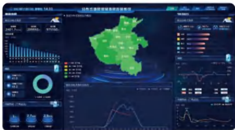
图 2 某 AGC 控制策略界面，可实时查看、动态调整控制策略。
